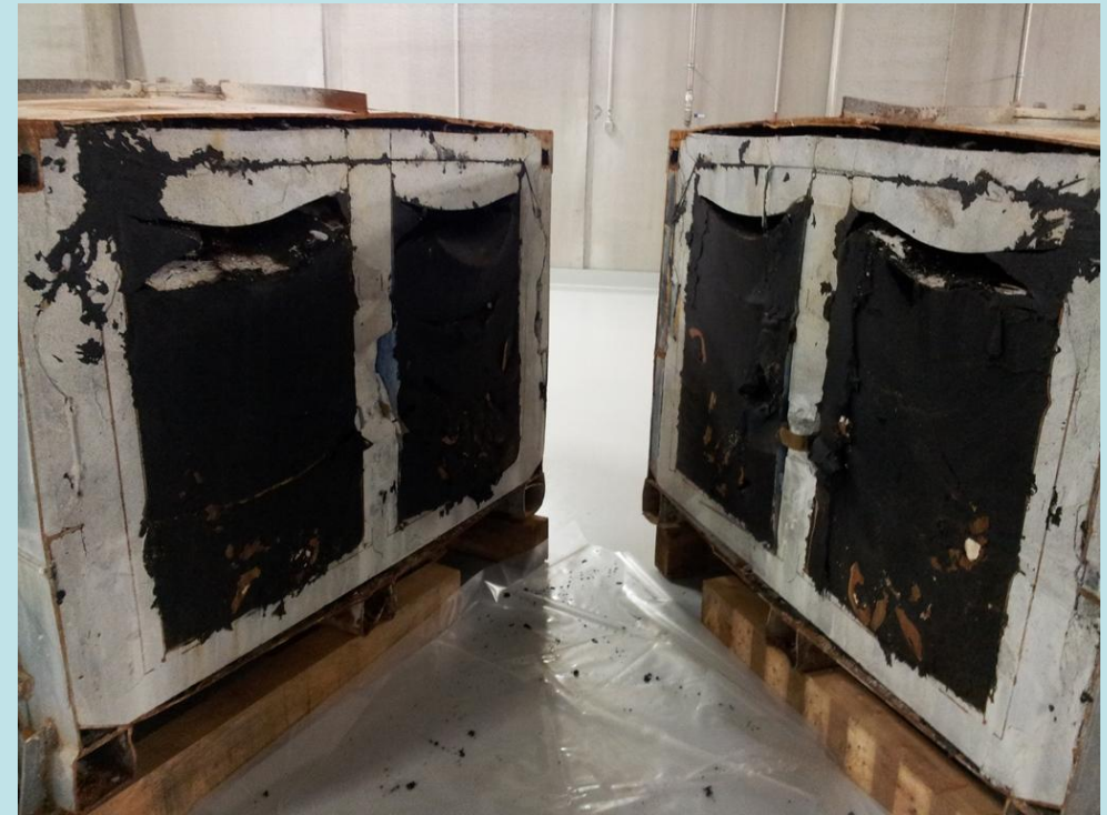
Sezione di un contenitore di prova dopo test ad alta temperatura
