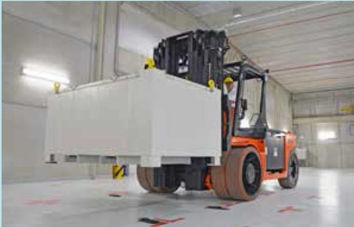
Contenitore per rifiuti condizionati 5.2 m 3 – acciaio - cemento
